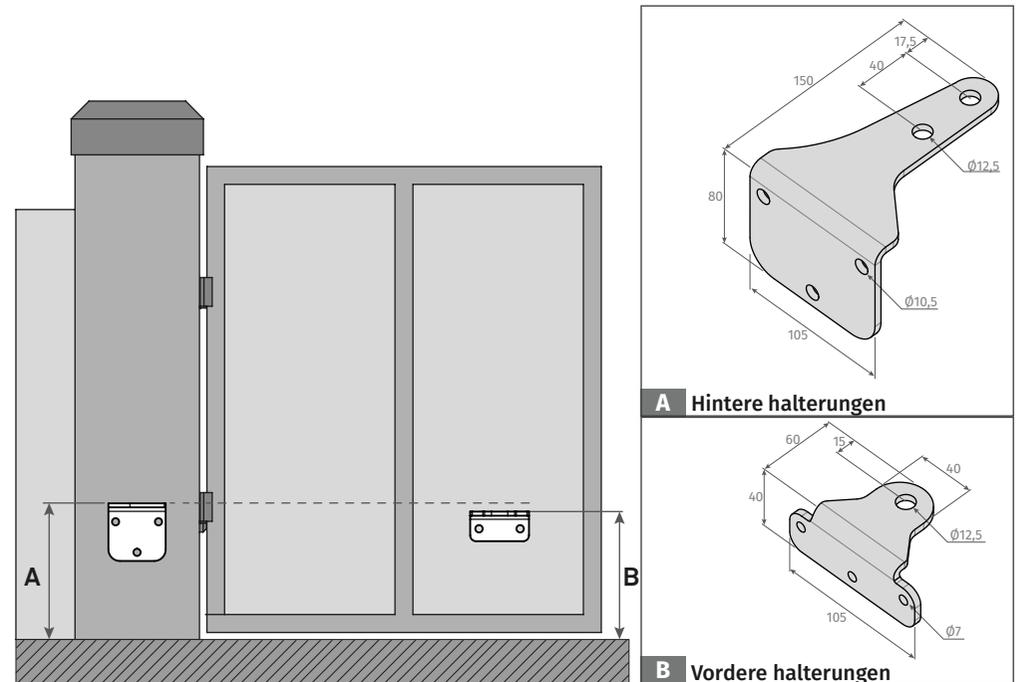
**Quote A** • Vertikaler Abstand vom Boden bis zur Oberkante der Rückhalteplatte, der hinteren Halterung.
